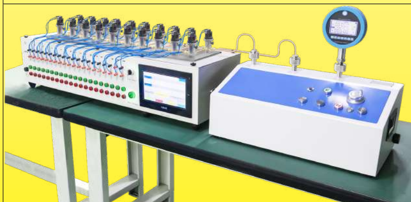
Vérification de l'étalonnage des pressostats
